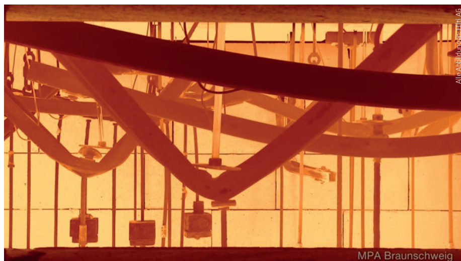
Abbildung 1: Verformungen von Montageschienen unter erhöhten Temperaturen
