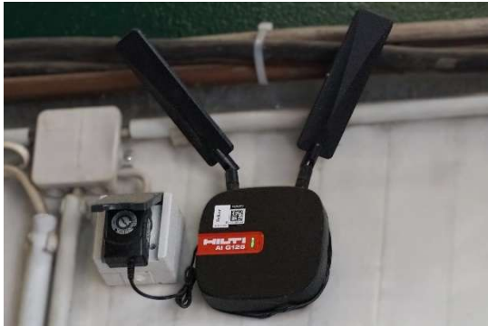
Bild 3: Automatisierte Erfassung von Geräten im Lager mit dem Gateway.
