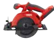
SC 4 WL-22 Handkreissäge für Holz Sägeblatt links / Blatt 165 mm Schnitttiefe 57 mm
