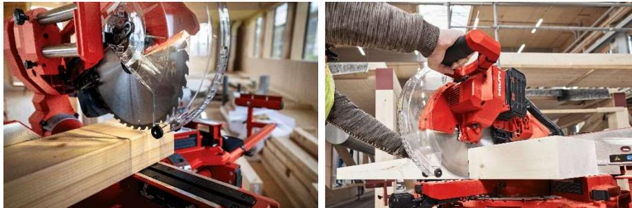
**Bild 1:** Die Schnittlinie wird durch den Schatten des Sägeblatts präzise auf die Werkstückoberfläche geworfen.
