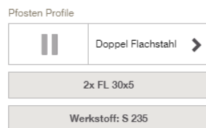
direkt angeschweißtes Doppel Flachstahlprofil auf Ankerplatte für Geländerquerstreben
