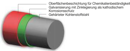
S-BT Kohlenstoffstahlbolzen mit Duplexbeschichtung
