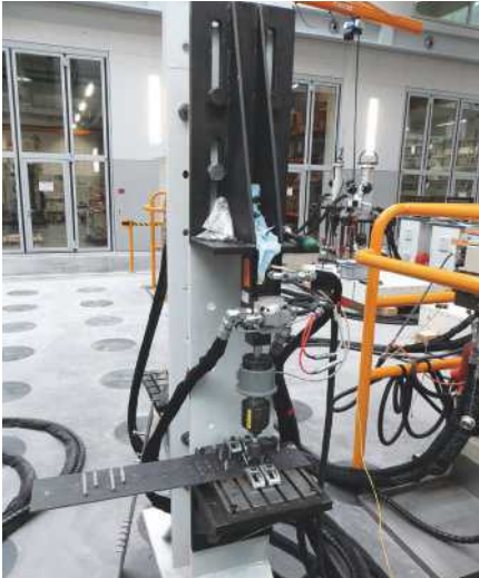
Prüfanordnung Zugfestigkeit unter zyklischer Belastung
