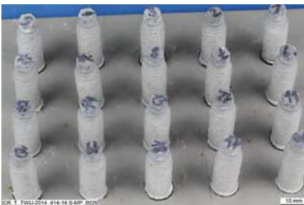
Vorbereitete S-BT Gewindeschraubbolzen
