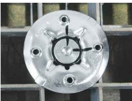
Markierungen zum Messen der Scheibendrehung
