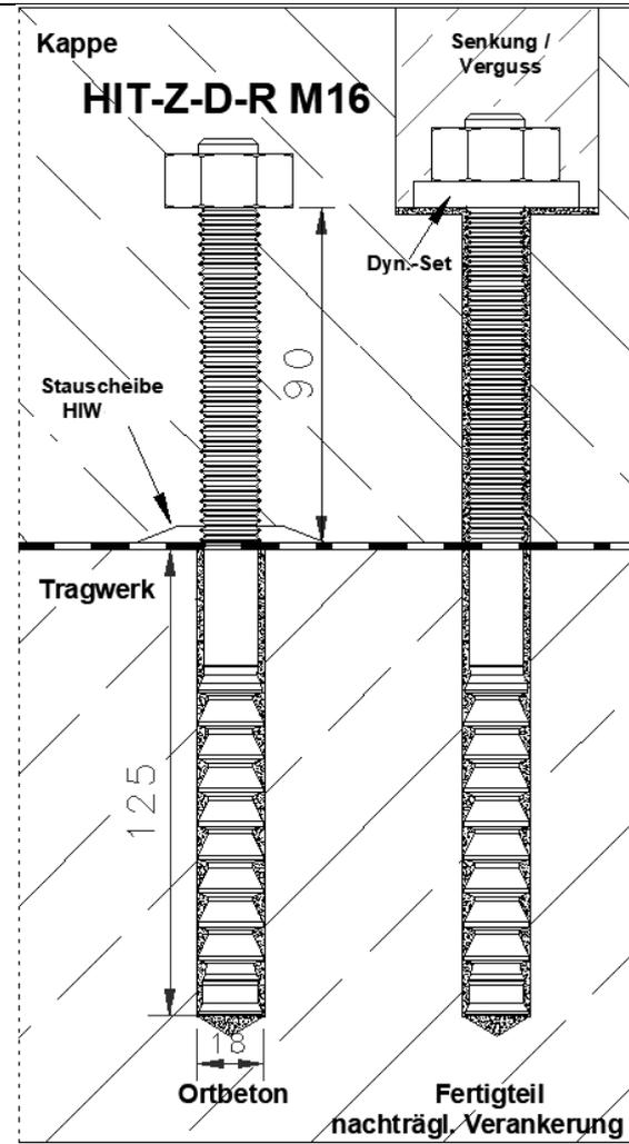
**Technische Daten Kappenverankerung für Ortbeton- / Fertigteil-Kappen und nachträgliche Verankerung**
