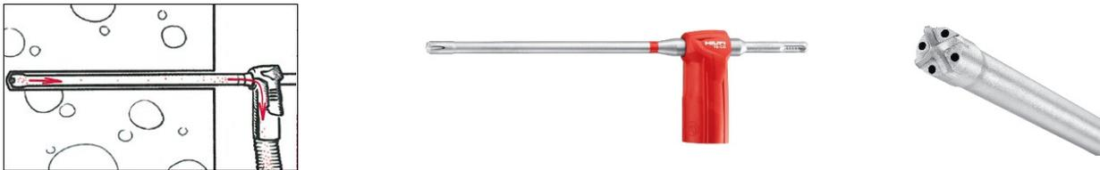
Bei Verwendung des Hohlbohrers mit passendem Bauentstauber Klasse M ist keine weitere Bohrlochreinigung erforderlich! Das Bohrmehl wird beim Bohrvorgang kontinuierlich durch den Schaft des Hohlbohrers abgesaugt, das Bohrloch somit automatisch gereinigt.
