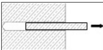
**Bohrkern brechen und entfernen, Bohrtiefe kontrollieren**
