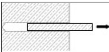
**Bohrkern brechen und entfernen, Bohrtiefe kontrollieren**
