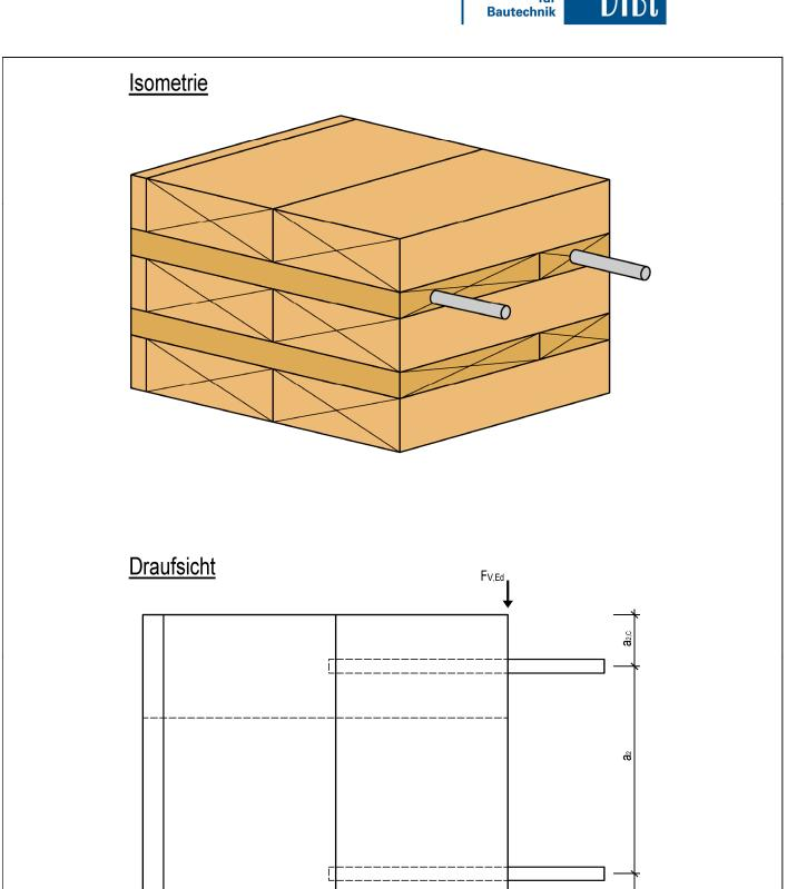
Verbindungen mit in Holzbauteilen eingeklebten Stahlstäben unter Verwendung des 2K-EP-Klebstoffs (Injektionsmörtel) Hilti HIT-RE 500 V4
