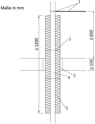
Rohrabhängung Ringspaltverfüllung gemäß Abschnitt 2.1.4 Stahldrähte gemäß Abschnitt 2.1.2 2/3
