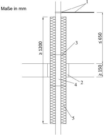
Rohrabhängung Ringspaltverfüllung gemäß Abschnitt 2.1.4 Stahldrähte gemäß Abschnitt 2.1.2 1
