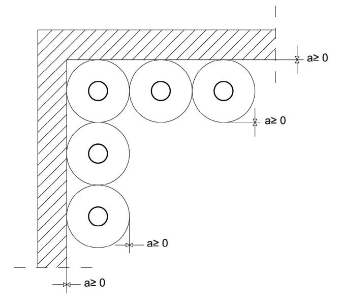
Zwickel sind hohlraumfüllend dicht in Bauteildicke zu verschließen.
