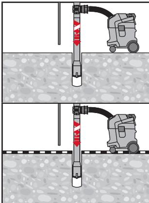
Ist auf der Betonoberfläche eine Dämm- oder Abdichtungsschicht vorhanden, ist diese mittels Standardbohrer vorzubohren, um eine Verstopfung des Hilti Hohlbohrers zu verhindern.
