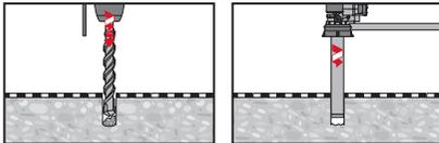
Bohrloch mit der erforderlichen Bohrlochtiefe erstellen:
