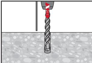
Bohrloch mit Bohrhammer drehschlagend, unter Verwendung des spezifischen Bohrerdurchmessers mit der erforderlichen Bohrlochtiefe erstellen:
