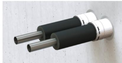
Nichtbrennbare Leitungen mit brennbarer Dämmung können bei Massivwänden  $\geq 200$  mm mittels Brandschutzbandage CFS-B direkt nebeneinander verlaufen (Nullabstand).
