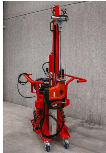
**Bild 3: Hilti semi-automatische Bohreinrichtungen**
