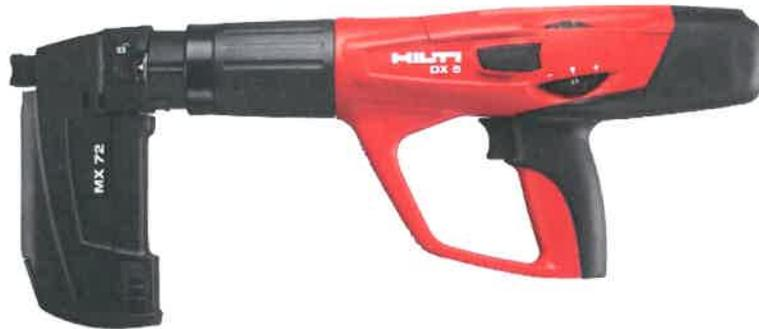
**Magazinierte Setzbolzen (Nägel)
